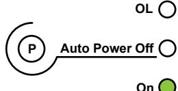
Automaattinen sammustustoiminto on poissa käytöstä pihdin ollessa kytkettynä sähköverkkoon. Mikäli yhteys sähköverkkoon katkeaa, jatkuu virtapihtien toiminta paristojen avulla ja automaattinen sammustustoiminto on jälleen aktiivinen (laite sammuu 10 min kuluttua).
