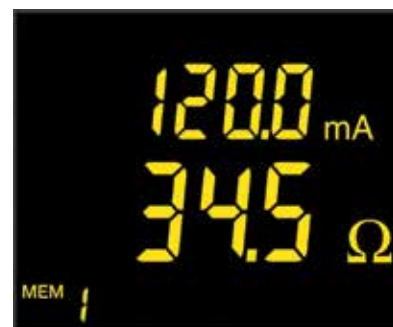
Standardläge: Slingresistans och läckström
