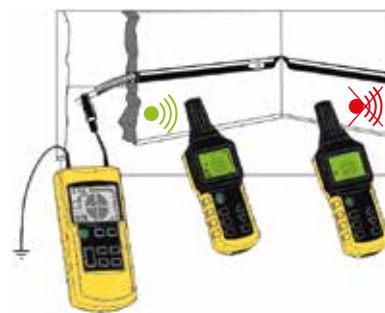
Virheellisesti taivutettujen vesiputkien havaitseminen
