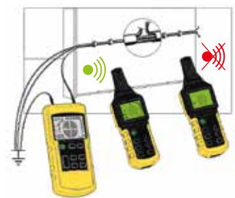
Katkoksen paikannus Nopea, yksinkertainen menetelmä seinässä sijaitsevan katkoksen tunnistamiseksi
