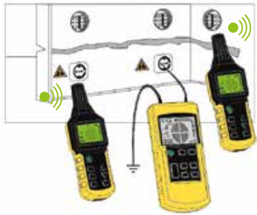
Johtojen sekä pistorasioiden seuraaminen ja paikannus 2:lla eri menetelmällä, riippuen asennuksesta
