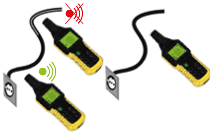
Verkkojännitteen sekä johdoissa sijaitsevien katkoksten tunnistami- nen
