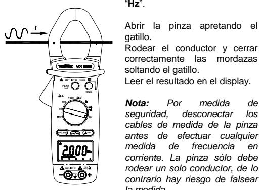
**Nota:** Para hacer las medidas de frecuencia, por lo tanto, se pueden utilizar los bornes de entrada (tensión) o las mordazas de la pinza (corriente), pero nunca se deben utilizar las dos fuentes a la vez.
