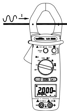
Posizionare il commutatore su "Hz".
