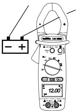
Stellen Sie den Wahlschalter auf 1000 A  $\Delta$ . Drücken Sie die Taste  $\sim/\equiv$ , um das Symbol  $\equiv$  (Gleichstrom) anzuzeigen.
