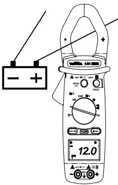
Posicionar el conmutador en 1000 A  $\Delta$ . Pulsar la tecla  $\sim/\equiv$  para visualizar el símbolo  $\equiv$  (señal continua). Una vez estabilizada la visualización, pulsar la tecla **AREL** para efectuar un ajuste automático del cero DC. Luego, seguir el mismo procedimiento que en la medida de corriente alterna. Ver § precedente.
