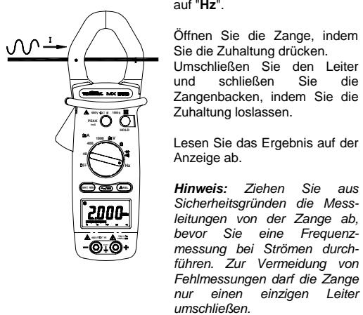
**Hinweis:** Zur Durchführung von Frequenzmessungen können also die Eingangsklemmen (Spannung) oder die Zangenbacken (Strom) verwendet werden. Verwenden Sie jedoch niemals beide Quellen gleichzeitig.
