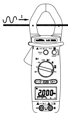
Positionner le commutateur sur "Hz".
