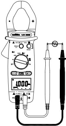
Posizionare il commutatore su "Hz".
