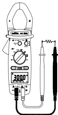
Posicionar el conmutador en  $\Omega$ . Conectar el cable de prueba rojo al borne de entrada "+" y el negro al borne de entrada "COM". Poner las puntas de palpador en contacto con los puntos a medir y leer el resultado en el display.
