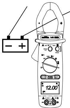
Posizionare il commutatore su 1000 A  $\Delta$ . Premere sul tasto  $\sim/\equiv$  per visualizzare il simbolo  $\equiv$  (segnale continuo).
