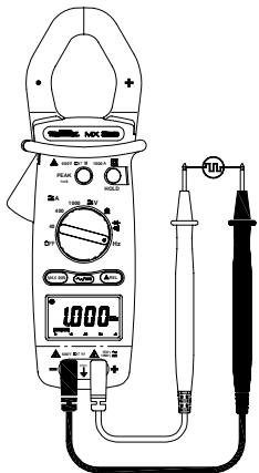
Positionner le commutateur sur "Hz".
