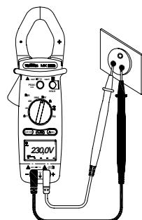
Collegare il cavo di test rosso alla boccola d'ingresso "+" e il cavo di test nero alla boccola d'ingresso "COM".
