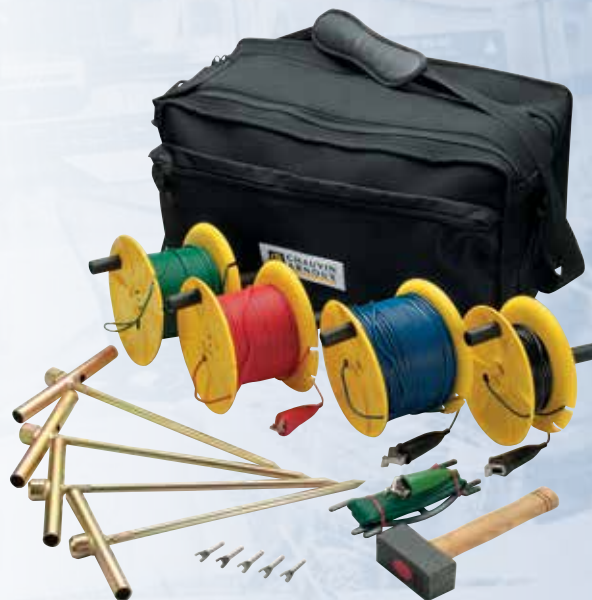
Maadoitusvastuksen ja maaperän resistiivisyyden mittaussarja P01102024 maadoitusvastuksen mittaukseen 3 tai 4 -napamenetelmällä sekä maaperän resistiivisyyden testaus uudiskohteissa (kantolaukulla).
