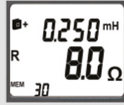
Näyttö 3: Silmukkavastuksen resistiivinen ja induktiivinen osa
