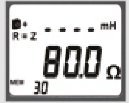
Selitys: induktiivinen osa on mitoitettävissä R = Z
