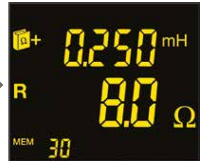
Näyttö 3: Silmukkavastuksen resistiivinen ja induktiivinen osa
