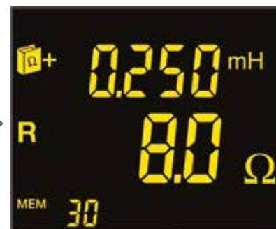
Skärm 3: Mätvärden på resistiv och induktiv del på den uppmätta slingresistansen
