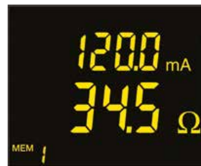
Standardläge: Slingresistans och läckström
