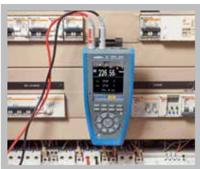
MultiFix-magneetti mahdollistaa käyttäjälle täysin vapaat kädet mittausten ajaksi.
