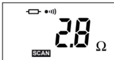
Välillä  $300\ \Omega$  ja  $3\ M\Omega$ , on laite vastus -tilassa. Yli  $3\ M\Omega$ , ilmoittaa näyttö OL (mittausalueen ylitys).  $30\ M\Omega$ :n alue ei ole käytettävissä automaattisessa toimintotilassa; käytä Vastus -tilaa
