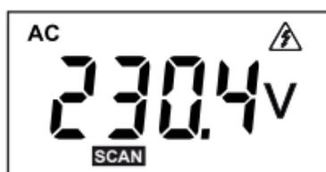
Mikäli jännitteen arvo on  $> 30\text{ V}$ , ilmoittaa laite vaarallisesta jännitteestä laitteen näytöllä kuvakkeella
