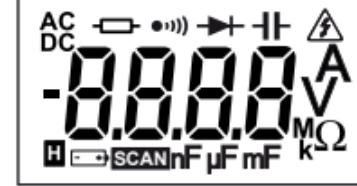
Mikäli paristojen jännitetaso on liian alhainen, vilkuu  $\text{---} \rightarrow$ -kuvake laitteen näytöllä.
