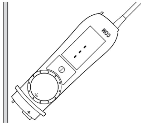
Hvis der ikke detekteres en AC spænding viser displayet **EF**.
