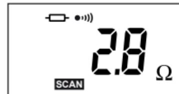
Under  $30\ \Omega$ , afgiver instrumentet en akustisk lyd. Mellem  $300\ \Omega$  og  $3\ M\Omega$ , mäter instrumentet modstand. Over  $3\ M\Omega$  viser displayet **OL**.  $30\ M\Omega$  området kan kun bruges i funktionen modstand  $\square$ .
