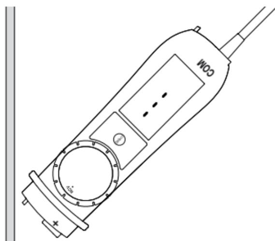
Mikäli laite ei havaitse AC jännitettä, ilmestyy laitteen näytölle teksti **EF**.
