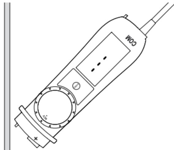
Om ingen växelspanning detekteras, visar instrumentet **EF**.
