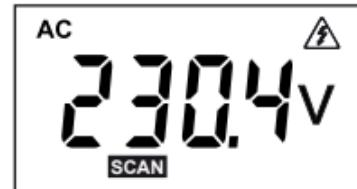
Mikäli jännitteen arvo on > 30 V, ilmoittaa laite vaarallisesta jännitteestä laitteen näytöllä
