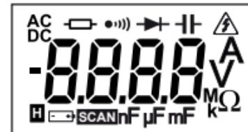
Om batterispänningen är för låg för ett korrekt fungerande instrument, visas symbolen  $\ominus +$ .
