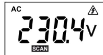
Om spänningen är > 30 V, visar instrumentet
