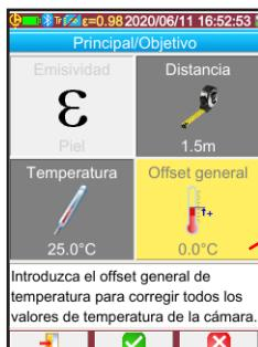
Ajuste el offset general (diferencia de temperatura entre la frente y la temperatura interna) a  $2^{\circ}\text{C}$ .
