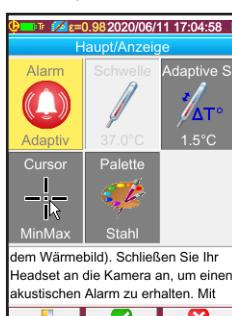
dem Wärmebild). Schließen Sie Ihr Headset an die Kamera an, um einen akustischen Alarm zu erhalten. Mit
