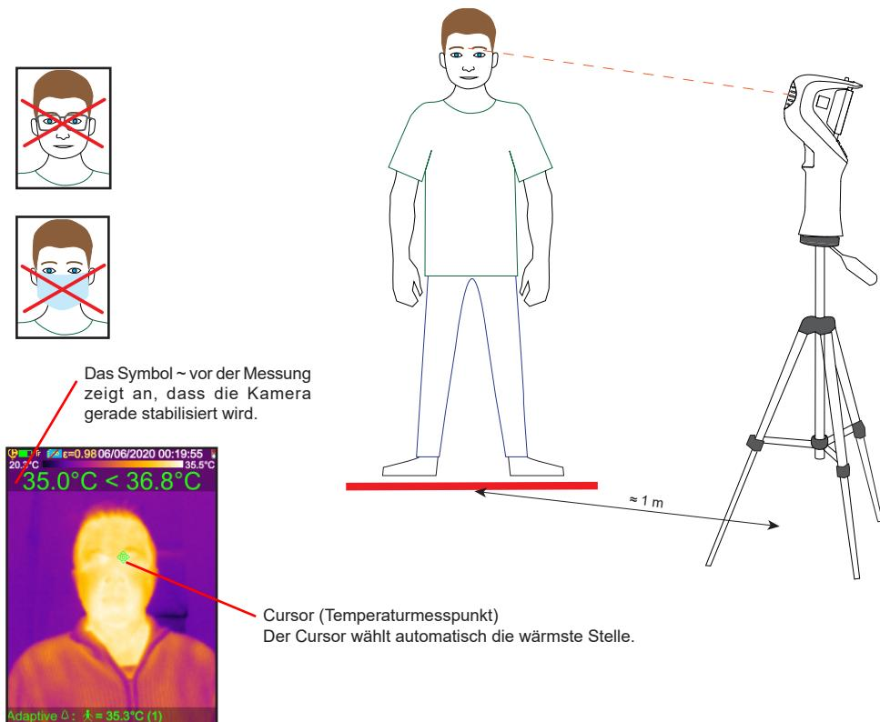
Wenn der Alarm ausgelöst wird, überprüfen Sie zunächst, ob der Cursor im Augenwinkel bzw. an der Stirn der Person misst. Wenn der Cursor am Hals misst, muss die geprüfte Person ihren Hals mit der Hand verdecken. Machen Sie zur Kontrolle eine Messung mit einem Fieberthermometer..
