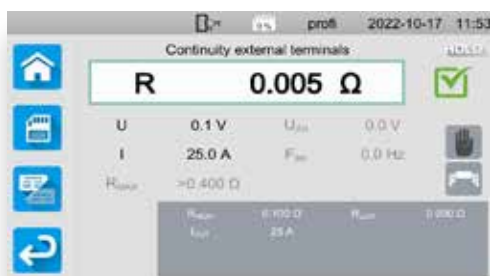
Exempel på resultatskärmen i det detaljerade visningsläget vid en 4-tråds kontinuitetsmätning med 25 A (CA 6163)
