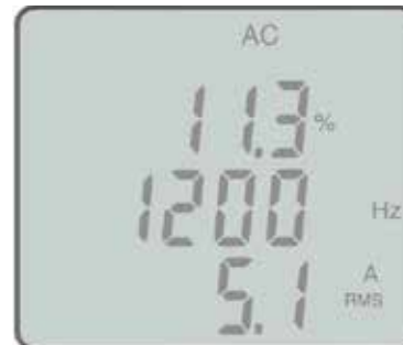
F407 näyttö H3; 3:n yliaallon mittausta 400 Hz:n verkossa.
