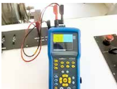
Här, är kanal 1 på HandScope® ansluten till rotorn via en BNC/Banan adapter.
