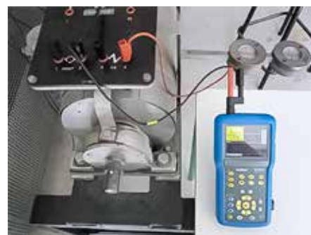
Med HandScope® oscilloskop mäts resistansen
