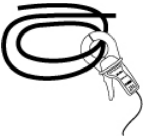
Kuva 10. Johdin voidaan kietoa monikertaiseksi mittaustarkkuuden parantamiseksi
